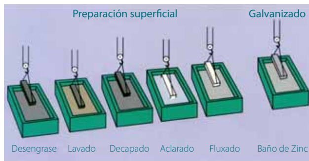
Figura 2.- Esquema del proceso de galvanización en caliente.
