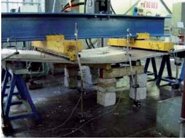
Figura 3.- Ensayo en un elemento fabricado con Hormigón de Ultra-Altas Prestaciones.
