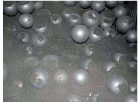
Figura 2.- Aspecto de un molino de cemento en a) ausencia de aditivo de molienda y b) en presencia de aditivo de molienda.
