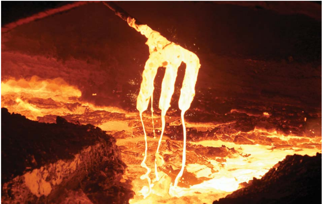
Figura 1.- Sangrado de la escoria (Foto cortesía de Fehs).
