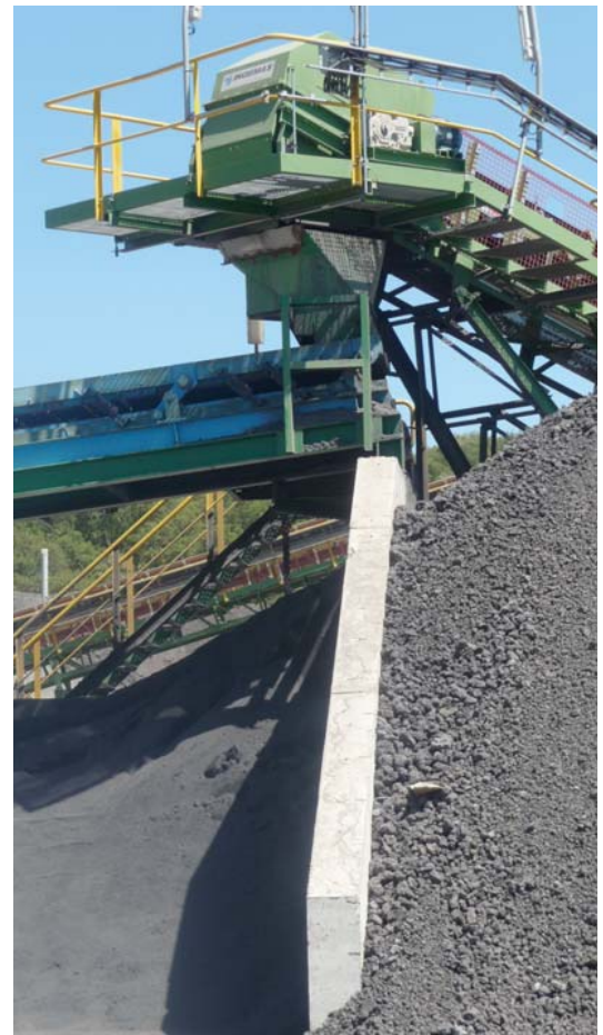
Figura 8.- Producción de áridos artificiales siderúrgicos (Foto cortesía de UNESID).
