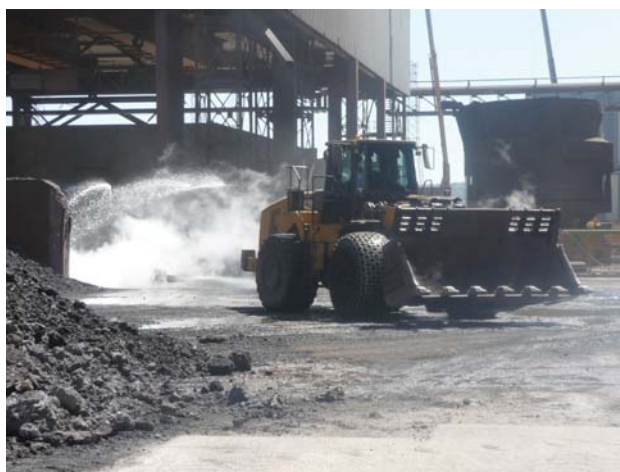
Figura 5.- Manipulación de las escorias en la instalación siderúrgica.
