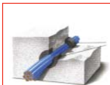
Figura 3. Sistema de masilla intumescente para el sellado de cables, bandejas y mazos de cables.
