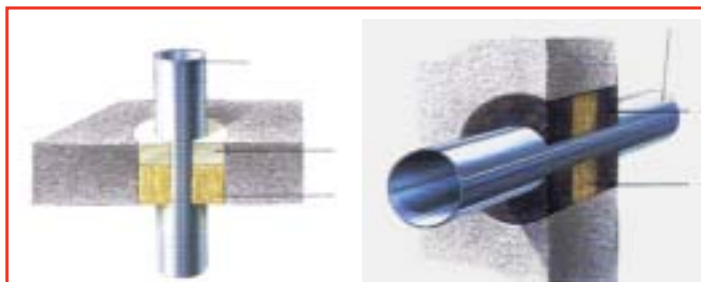
Figura 2. Sistemas de masilla ignífuga, para el sellado de conductos no combustibles.
